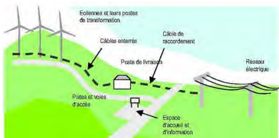
Description générale d'un parc éolien (source SER-FEE)
